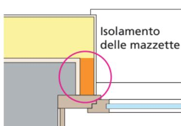
Quando si sostituiscono le finestre, bisogna proteggere le mazzette con almeno 4 cm d'isolante. Se ciò non è possibile subito, per il successivo isolamento termico delle facciate va prevista un'adeguata misura luce della finestra.
