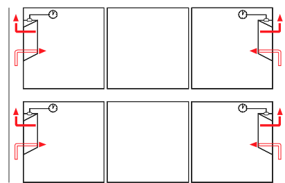
Aération automatique par les fenêtres [3]
