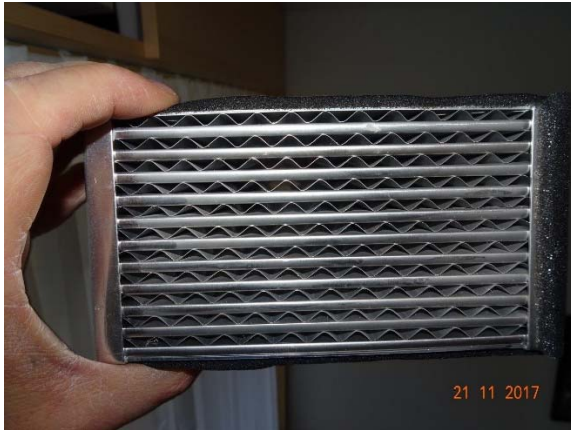
Abbildung 34: WNG ID 120: Wärmetauscher
