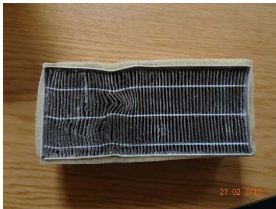
Abbildung 220: WNG ID 1010: Zuluftfilter
