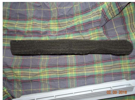
Abbildung 175: WNG ID 730: Zuluftfilter
