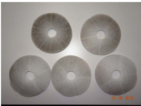
Abbildung 206: WNG ID 910: Zuluftfilter
