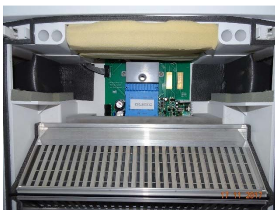
Abbildung 56: WNG ID 220: Wärmetauscher
